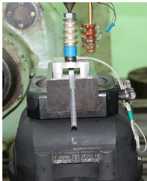
Рис. 5. Общий вид приспособления для закрепления образцов во время проведения эксперимента
