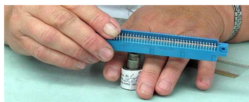
Рис. 2. Ручной процесс контроля силы расчленения контакта
