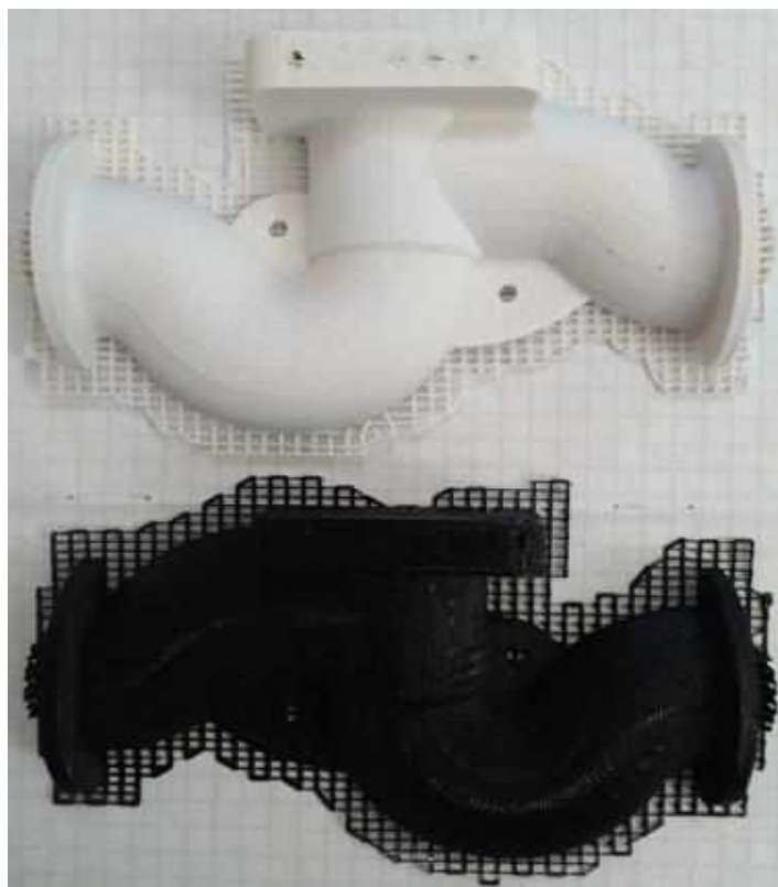
Рис. 1. Литейные полумодели (ABS, PLA) корпуса запорной арматуры, полученные с использованием 3D-принтера Makerbot Replicator 2
