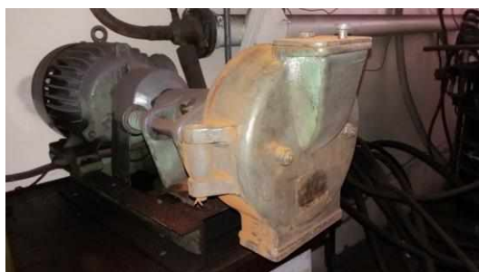
Рис. 1. Истирающая машина ИДА-175
